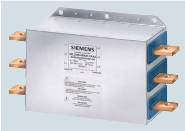
Zur Begrenzung der Störaussendung sind die Umrichter standardmäßig mit einem Funk-Entstörfilter gemäß der in Kategorie C3 festgelegten Grenzwerte ausgestattet. Durch Verwendung des Netzfilters erfüllt SINAMICS G130 auch die Grenzwerte für den Einsatz in der ersten Umgebung (Kategorie C2) nach EN 61800-3<sup>1)</sup>.
