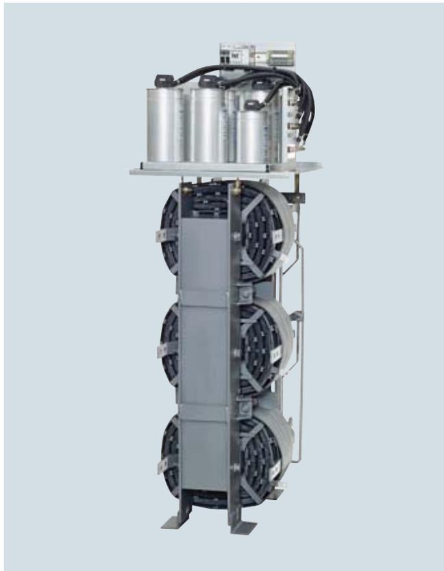
Anstelle der Netzdrossel wird ein Line Harmonics Filter in den Schaltschrank integriert, welcher die prinzipbedingt auftretenden Oberschwingungen minimiert. Damit werden die Grenzwerte der Norm IEC 61000-3-2 ausnahmslos eingehalten (Voraussetzung:  $u_k \leq 5\%$  bzw.  $RSC \geq 20$ ).
