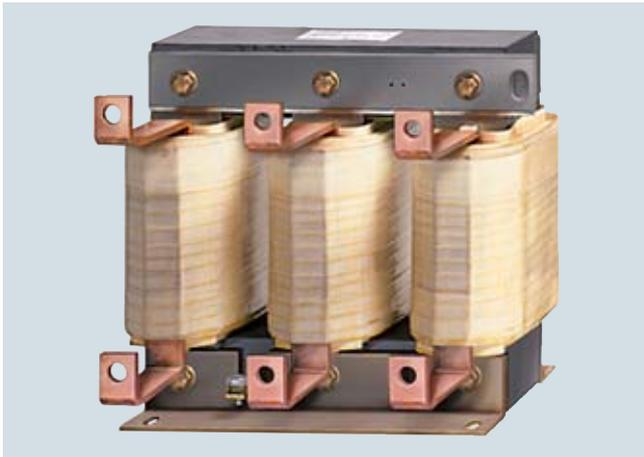
Motordrosseln reduzieren die Spannungsbelastung der Motorwicklungen, indem die durch den Umrichterbetrieb hervorgerufenen Spannungsteilheiten an den Motorklemmen verringert werden. Gleichzeitig werden auch die kapazitiven Umladeströme reduziert, die den Umrichteranschluss beim Einsatz langer Motorkabel zusätzlich belasten. Die max. zulässige Ausgangsfrequenz beträgt beim Einsatz einer Motordrossel 150 Hz.
