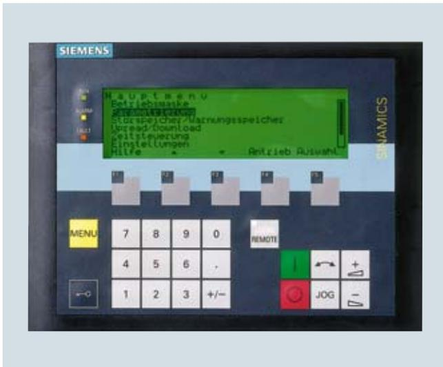
Zum Bedienen und Beobachten, sowie zur Inbetriebnahme, enthält der Umrichter in der Schranktür das Bedienfeld AOP30.
