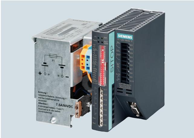
Durch die Kombination eines DC-USV-Moduls mit mindestens einem 24-V-Batteriemodul und einer SITOP-Stromversorgung werden längere Netzausfälle absolut unterbrechungsfrei überbrückt. Auch wenn ein größerer Pufferstrom benötigt wird, bietet die DC-USV mit wartungsfreien Blei-Akkus optimale Sicherheit. Sie überbrückt Netzausfälle bis in den Stundenbereich und liefert bis zu 40 A
