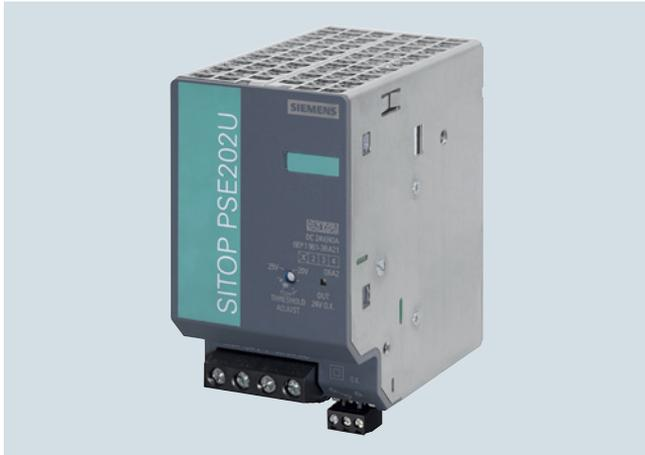
Die Redundanzmodule SITOP PSE202U sind die optimale Ergänzung für alle 24-V-Stromversorgungen, um einen zusätzlichen Schutz vor einem Ausfall der 24-V-Versorgung zu gewährleisten. Das Redundanzmodul überwacht kontinuierlich die einspeisenden Netzgeräte und beim Ausfall eines Gerätes übernimmt automatisch das andere die 24-V-Versorgung. Über einen Meldekontakt erfolgt zusätzlich eine Signalisierung, die einfach von einer Steuerung, einem PC oder einem Leitsystem ausgewertet werden kann.
