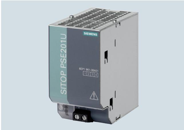
Das Puffermodul SITOP PSE201U überbrückt kurzzeitige Netzausfälle bis in den Sekundenbereich und kann mit allen 24-V-Netzgeräten der Produktlinien SITOP smart oder SITOP modular eingesetzt werden. Das Puffermodul besitzt als Energiespeicher wartungsfreie Kondensatoren und übernimmt bei Ausfall der Netzspannung automatisch die 24-V-Versorgung.
