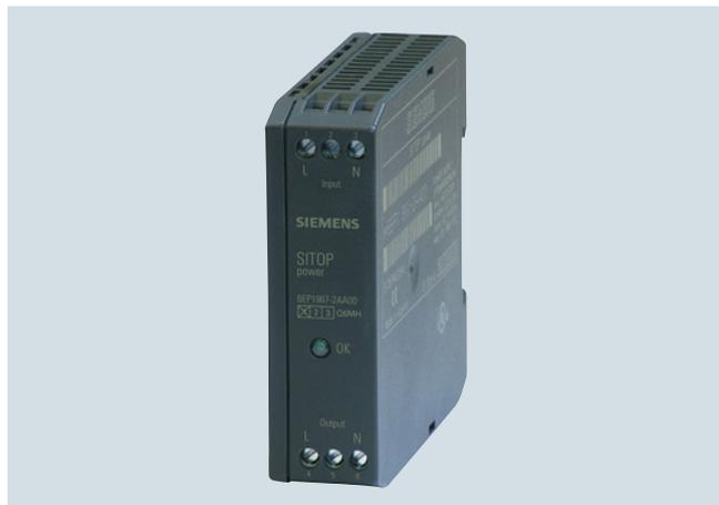
Der SITOP Einschaltstrombegrenzer dient zur sicheren Reduzierung von Einschaltströmen, wie sie z. B. durch Transformatoren bzw. bei getakteten Netzteilen durch die eingangsseitige Gleichrichterschaltung mit Kondensatorladung verursacht werden.
