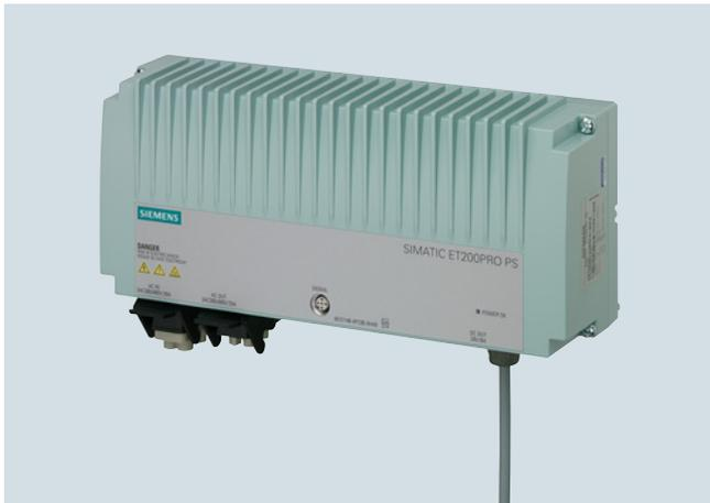
Das Netzgerät in Schutzart IP67 SIMATIC ET 200pro PS dient als Elektronik-/Geber- und Lastspannungsversorgung des Peripheriesystems SIMATIC ET 200pro für den maschinennahen, schaltschranklosen Einsatz. Mit Meldekontakt für „24 V O. K.“ und „Übertemperatur“ sowie einem zweiten Steckverbinder zum Weiterschleifen der Eingangsspannung.
