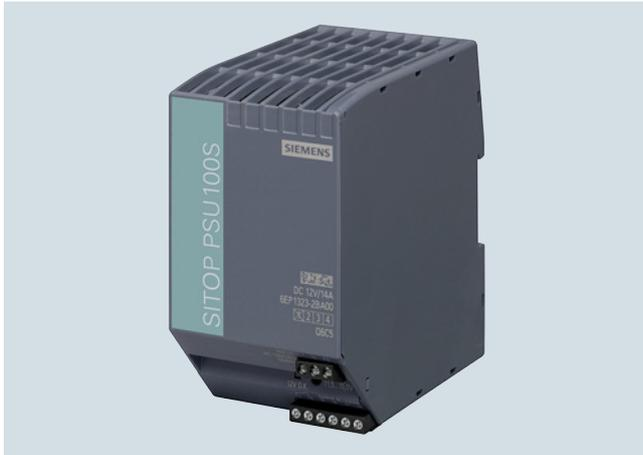
Die einphasigen SITOP smart sind die universellen und leistungsstarken Standardstromversorgungen für den Maschinen- und Anlagenbau. Trotz ihrer kompakten Bauform bieten sie ein hervorragendes Überlastverhalten: Dank Extra-Power von 150% lassen sich Verbraucher mit hohem Stromverbrauch problemlos zuschalten. Der hohe Wirkungsgrad sorgt für niedrigen Energieverbrauch und geringe Wärmeentwicklung im Schaltschrank.
