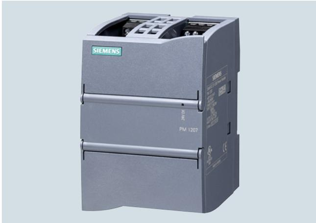
Die einphasige Laststromversorgung SIMATIC PM 1207 (PM = Power Modul) mit automatischer Bereichsumschaltung der Eingangsspannung ist in Design und Funktionalität optimal an die Steuerung SIMATIC S7-1200 angepasst. Sie versorgt CPUs mit 24-V-Eingang, Signalmodule und daran angeschlossene 24-V-Verbraucher. Umfangreiche Zertifizierungen wie UL, ATEX und DNV GL ermöglichen einen universellen Einsatz.
