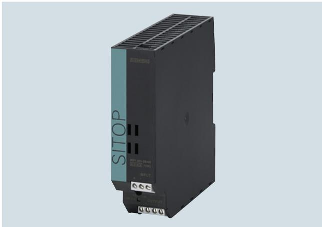
DC/DC-Wandler zum Anschluss mit fester Verdrahtung an 24-V-Gleichspannungsnetze. Ausgangsspannung DC 12 V, potenzialfrei, kurzschluss- und leerlaufest.
