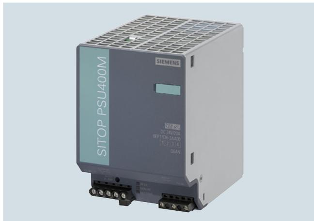
Die Stromversorgung SITOP PSU400M mit 600 V DC-Eingang eignet sich als effizienter DC/DC-Wandler für Antriebs- und Batteriesysteme; großer Eingangs- und Temperaturbereich, hoher Wirkungsgrad; schmale Bauform; mit 50 % Extra-Power für 5 s/min. Als Vorschaltgerät für die PSU400M ist als Zubehör ein Spannungsanstiegsbegrenzer verfügbar. Damit besteht die Möglichkeit den DC/DC Wandler direkt auf eine DC-Spannung bis zu 900 V DC aufzuschalten.
